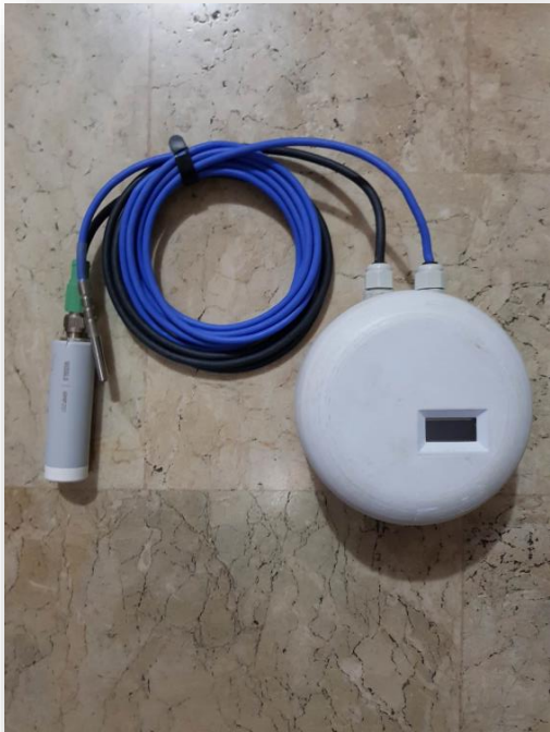
GMP251 – Vaisala CAN 24 bits Température pt100 Autonomie 1 mois
