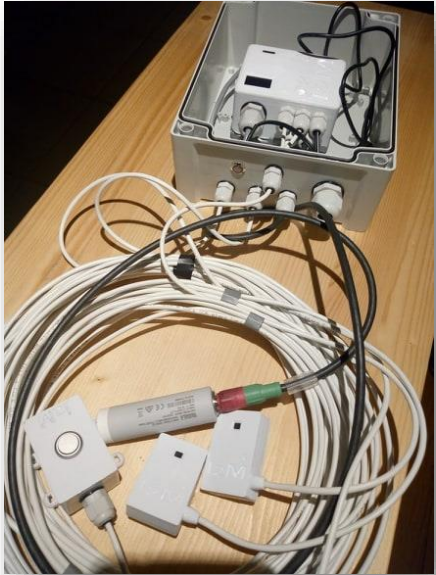
GMP251 – Vaisala CAN 16 bits Température ADT7410 16 bits 0,0078°C Bouton poussoir Alimentation 12V
